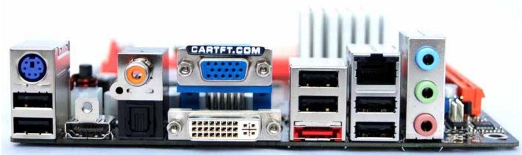
Das Zotac Mainboard besticht durch eine große Anzahl an Anschlussmöglichkeiten. Die gut ausgestattete I/O Blende bietet folgende Anschlussmöglichkeiten: 1x VGA (DSUB-15), 1x DVI, 1x HDMI, 6x USB 2.0, 1x eSATA, Audio, 1x LAN 10/100/1000 MBit, SPDIF (optical + coaxial), WLAN Antenna, 1x PS/2 (Keyboard).
