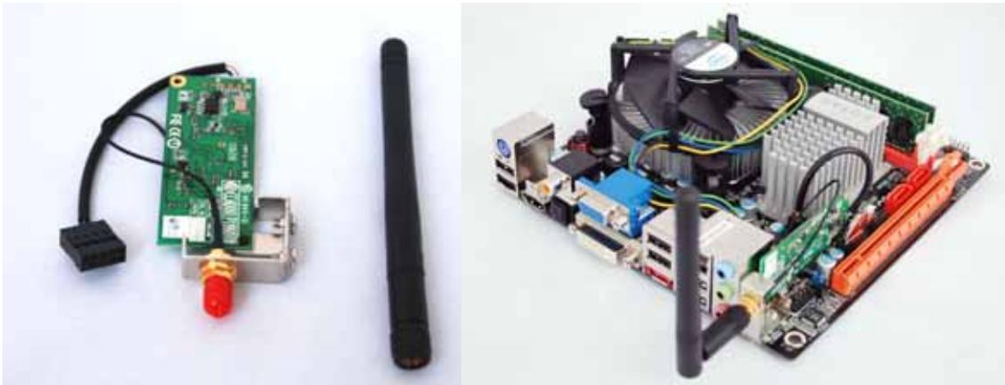
Ein weiteres Feature was besonders bei der Nutzung im Heimbereich von Vorteil ist, ist das im Lieferumfang enthaltene WLAN Modul das direkt auf dem Mainboard angebracht werden kann. Somit kann in der Gehäusewahl ein sehr kleiner Formfaktor erreicht werden und der Nutzer hat im Gegensatz zu anderen Mainboards ohne extra Zubehör die Möglichkeit kabellos zu surfen.
